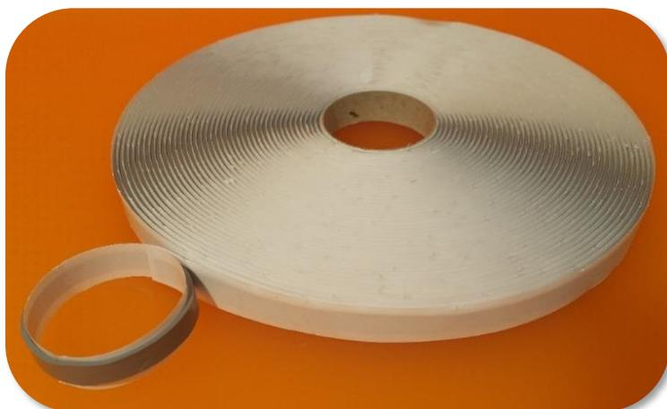
GAP AS-95 ist ein Vakuum-Dichtband für geringe Temperaturen. Es kann ideal für Prozesstemperaturen von bis zu 110°C eingesetzt werden und ist geeignet zum Kompaktieren und für Zwischenvakuum.
