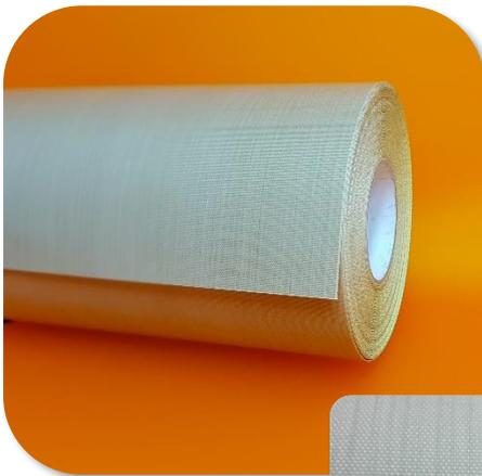
Die poröse PTFE-Beschichtung des Gaplon® Easy Release TFP bewirkt, dass überschüssiges Harz und eingeschlossene Luft während des Aushärtungsvorgangs in das Saugvlies entweichen.
