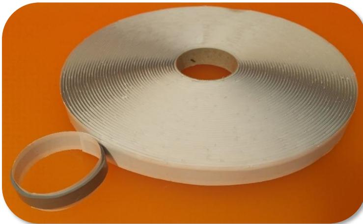
GAP AS-400B ist ein Vakuum-Dichtband für hohe Temperaturen. Bei Raumtemperatur besitzt das Dichtband hohe Klebkraft; somit ist eine optimale Vakuumabdichtung gegeben. Aufgrund der hohen Temperaturbeständigkeit, können mit Hilfe des Dichtbandes GAP AS-400B Thermoplasten verarbeitet werden.
